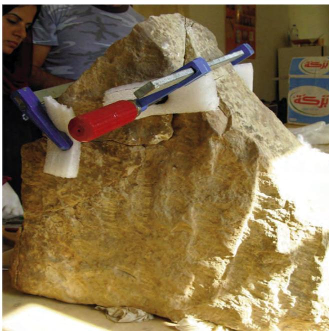
**Fig. 29** Fragmento de pared en proceso de Restauración.
